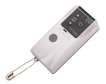
NDP-CO1A 是一种带有电化学式传感器的便携式 CO 警报器。具备 50、150ppm 的两级警报和 150 ppm·hr 的累计浓度警报,通过警报音和 LED 闪烁发出警报。主要在设有钢铁厂和燃烧设备的室内使用。
